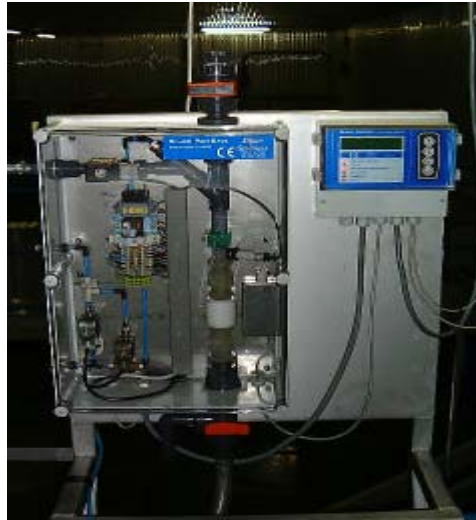
왼편의 감지기가 내장된 실험장치와 오른편의 컴퓨터장치를 포함한 제어장치인 Siljan PolySave의 사진.
